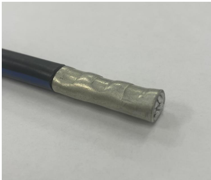
Рисунок 23 - Пример обжатия многожильного провода
